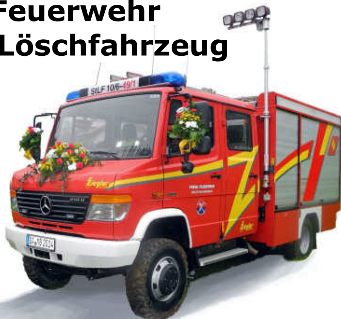
Staffellöschfahrzeug 10/6, 7,5 to, 130 kW/176 PS, 4-Zyl.-Diesel, Hubr, 4,3 L, 600 Liter Löschwassertank, Lichtmast, Steckleiter, 1000 L/Min Pumpe
